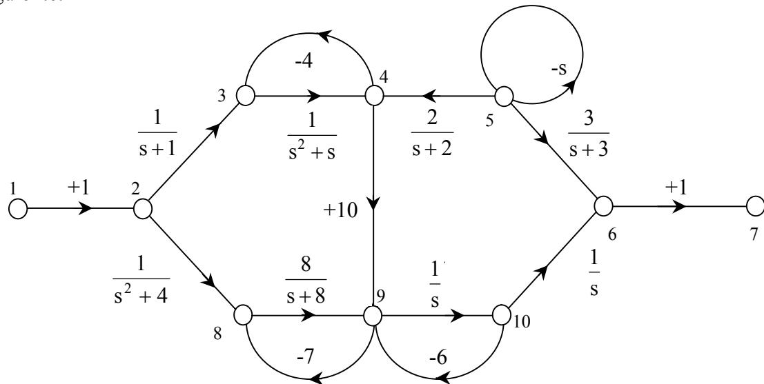
Calcular la función de transferencia de la planta, aplicando la regla de Mason.
